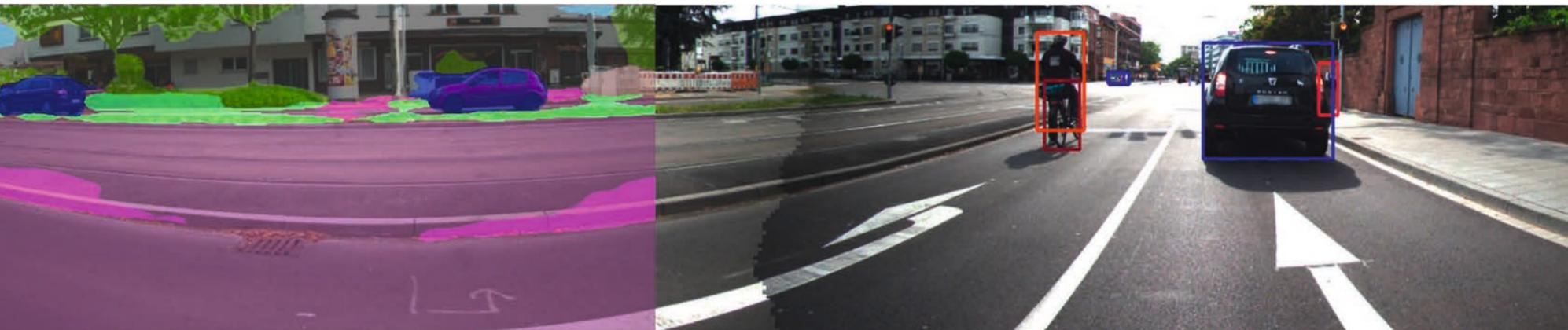
**Kameraverarbeitung:** Im linken Bild sieht man die semantische Segmentierung, im rechten Bild die Bounding-Box-Schätzung aus einem Kamerabild. Verschiedene Klassen sind jeweils in verschiedenen Farben dargestellt. Beispielsweise ist die Fahrbahn in lila dargestellt, Fahrzeuge sind hingegen in blau dargestellt.
