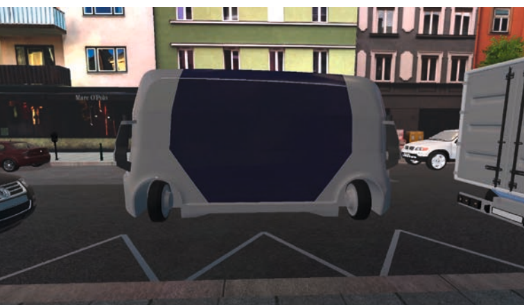
Strategie 3: Gegensinnige Allradlenkung mit einem Einschlagwinkel von 90°, welcher aber nur im Stand eingestellt werden kann.
