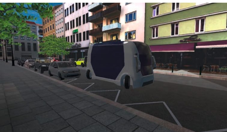
Strategie 2: Gleichsinnige dynamische Allradlenkung mit einem maximalen Einschlagwinkel von 63° bzw. 64°.
