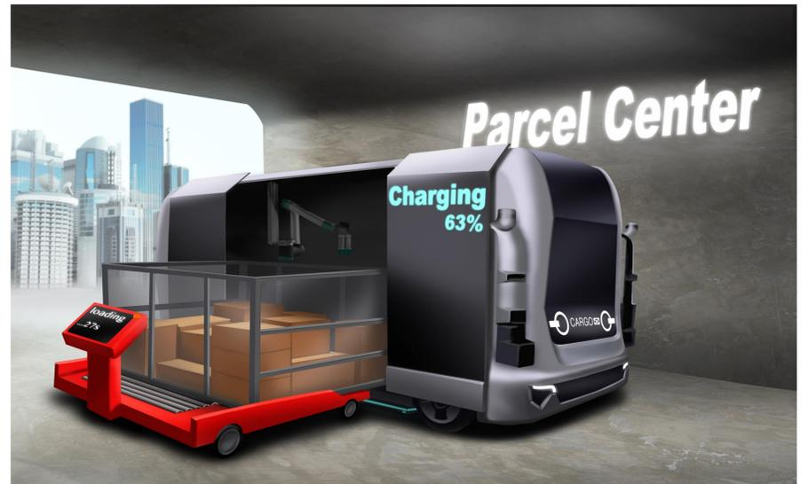
Paket-Ladecontainer im Paketzentrum wechseln | Fahrzeug-Batterien induktiv laden
